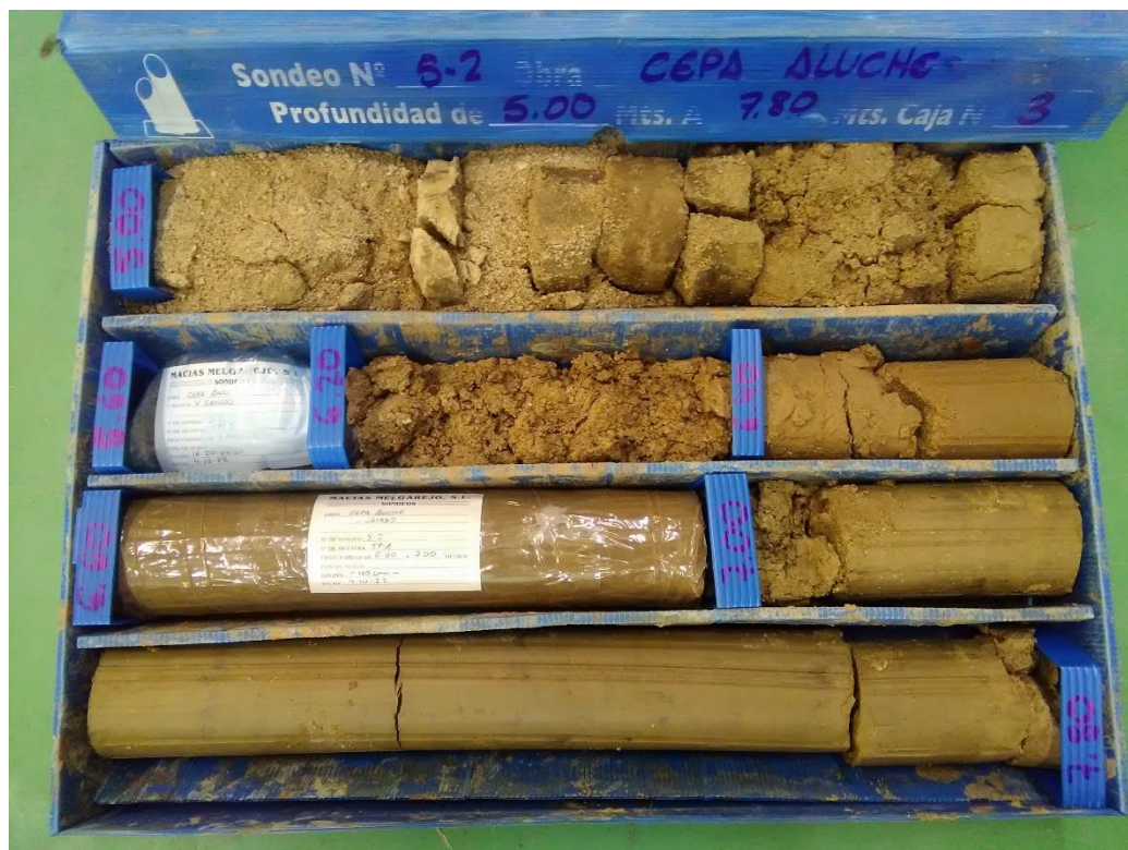
Sondeo S-2, caja 3, de 5,00 m a 7,80 m de profundidad.
