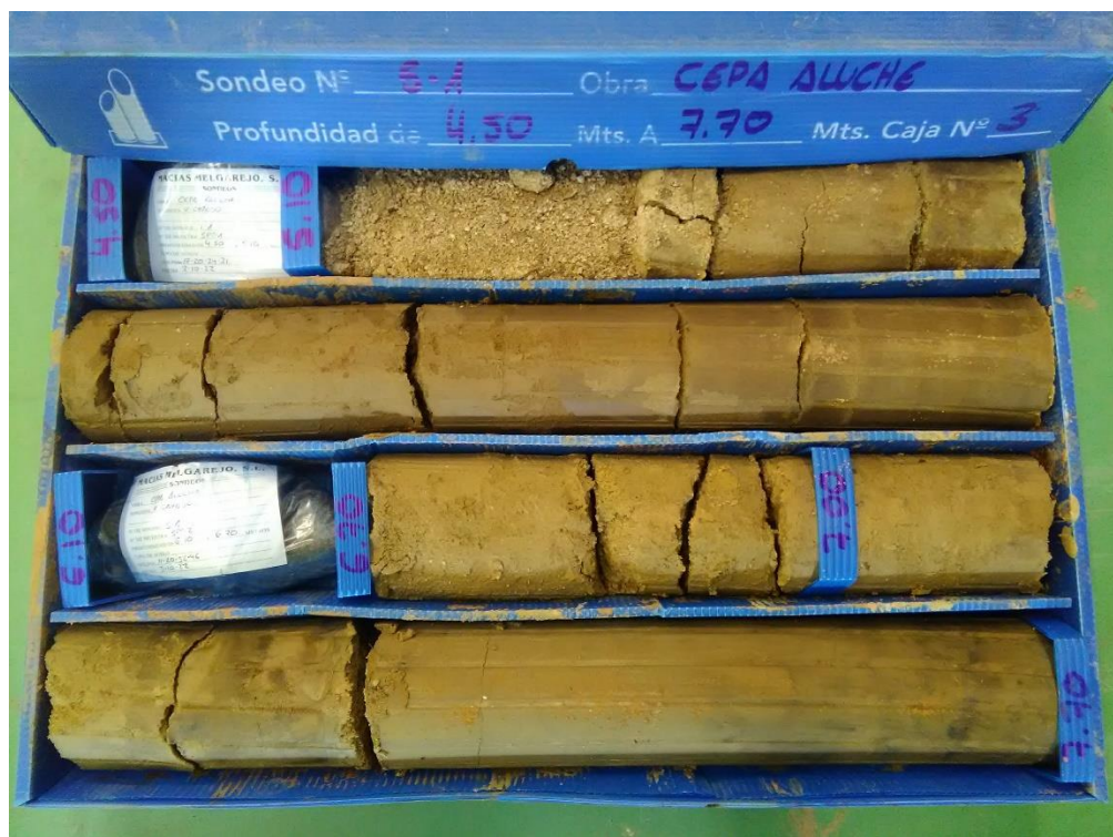
Sondeo S-1, caja 3, de 4,50 m a 7,70 m de profundidad.
