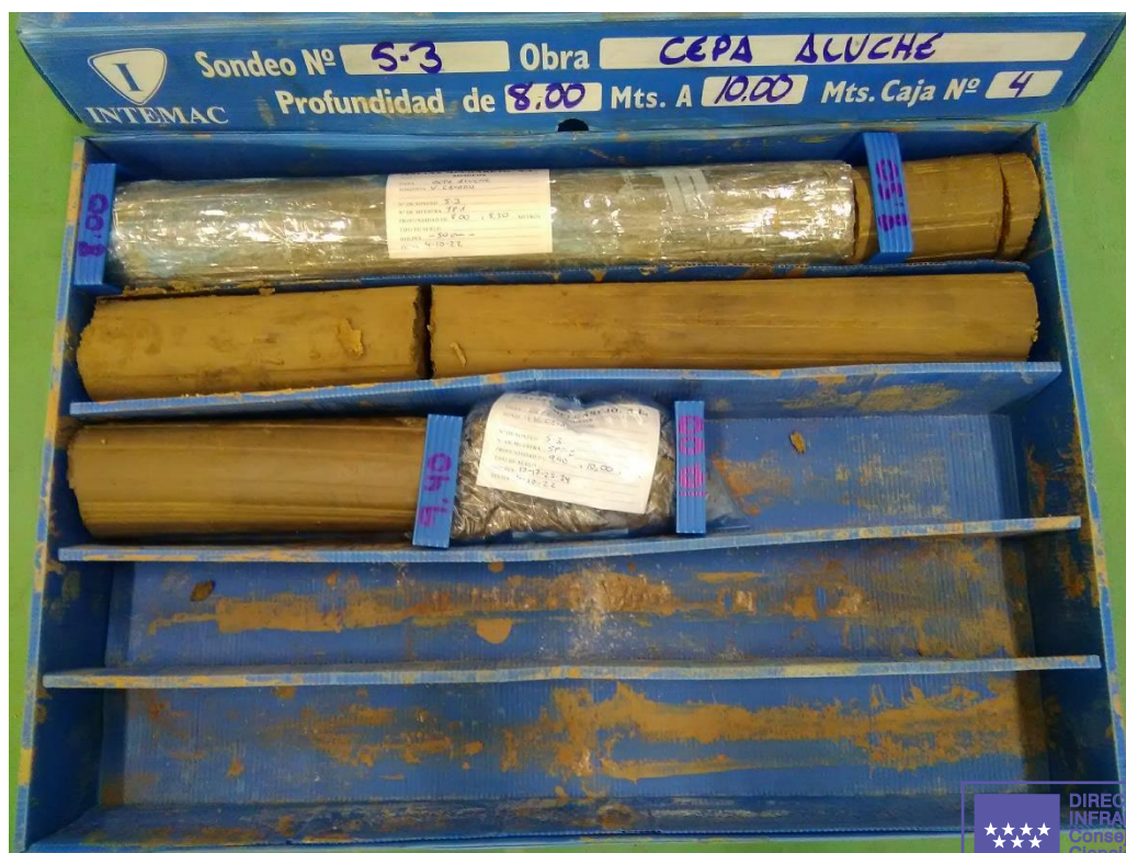
Sondeo S-3, caja 4, de 8,00 m a 10,00 m de profundidad.
