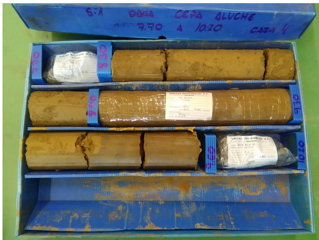
Sondeo S-1, caja 4, de 7,70 m a 10,20 m de profundidad.
