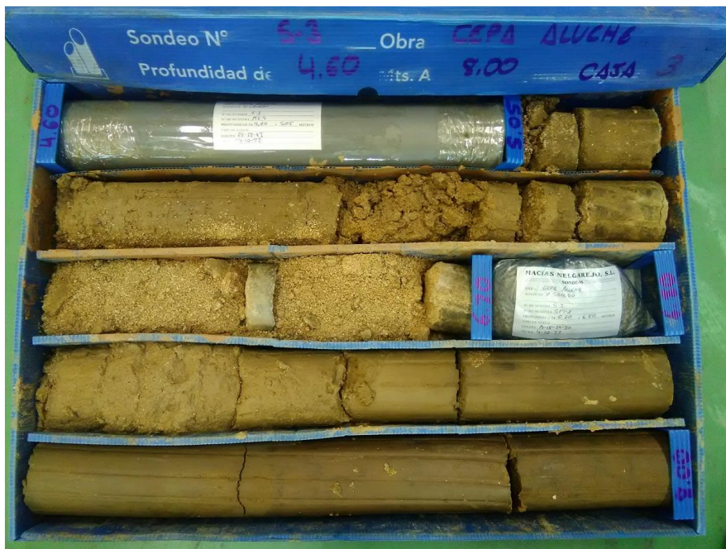
Sondeo S-3, caja 3, de 4,60 m a 8,00 m de profundidad.
