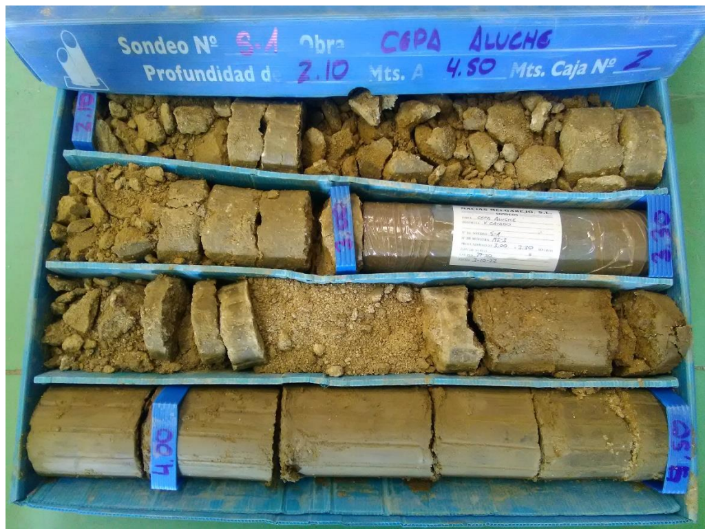
Sondeo S-1, caja 2, de 2,10 m a 4,50 m de profundidad.
