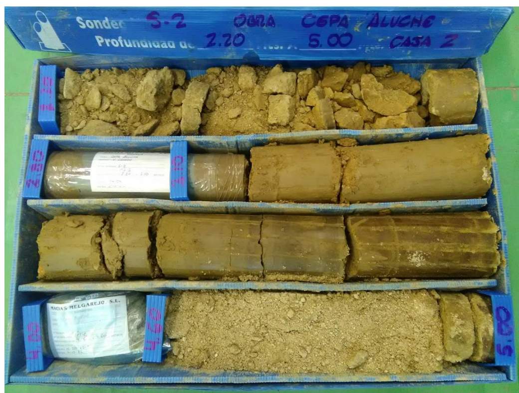
Sondeo S-2, caja 2, de 2,20 m a 5,00 m de profundidad.
