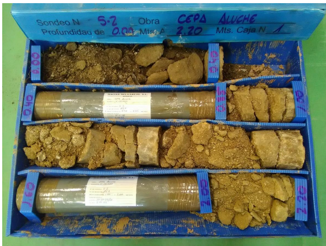
Sondeo S-2, caja 1, de 0,00 m a 2,20 m de profundidad.
