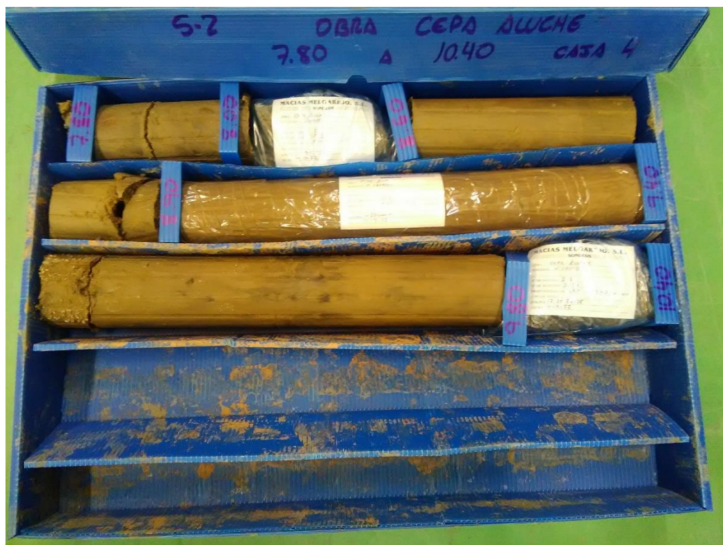
Sondeo S-2, caja 4, de 7,80 m a 10,40 m de profundidad.
