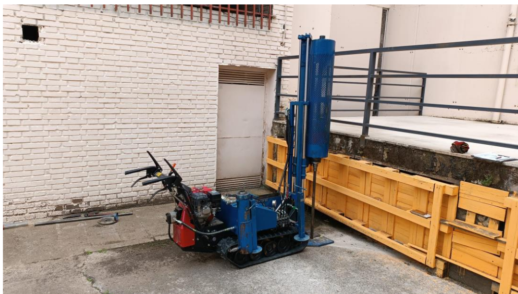
Fotografía 2. Equipo de penetración dinámica empleado en P-1.
